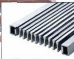
**Решетка «Пирания»** – грязезащитная решетка, состоящая из алюминиевых скребков, которые стянуты стальным тросом в группу, образующую единую систему грязезащитной решетки. Рекомендуется использовать для укладки покрытий внутри помещений и снаружи под крышей и служит для удаления крупной и средней фракции грязи.
